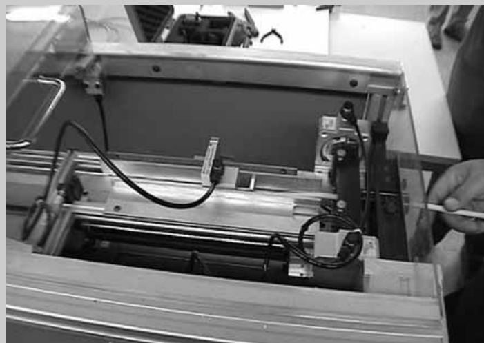
Oben: Kabelautomat der Kabel auf geplante Länge schneidet und fortlaufend bedruckt, um Verwechslungen beim werksseitigen Einlegen auszuschließen. Ein Abisolierautomat bereitet die Kabelenden für den Steckeranschluß vor.
