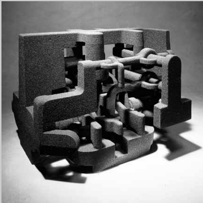
Oben: Funktionsprototyp einer hydraulischen Steuerung aus Gußeisen, in einem Stück durch Lasersintern hergestellt (FKM)
