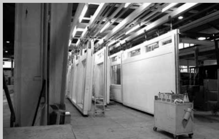
Rechts: In geneigter Position verglaste Dachfelder, unten: Fertige Wandelemente, verschiebbar auf Rollen gelagert
