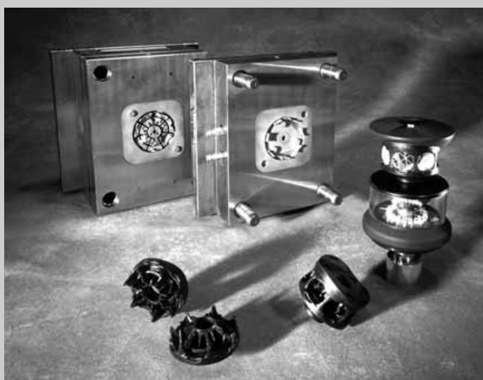
Links: Kunststoffverbindungsstücke für ein Kinderwagengestell, serienidentische Spritzgußteile (EOS)
