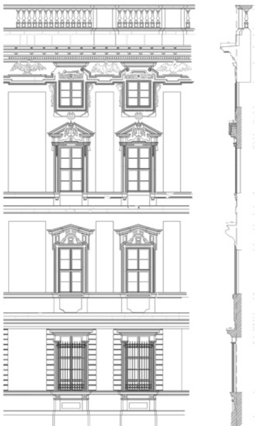
Auf Basis der Photogrammetrie können detailgetreue Rekonstruktionszeichnungen entwickelt werden. In die Zeichnungen fließen neben photogrammetrischen Daten auch Details aus Fotografien, historischen Plänen und der Bauforschung ein. Courtesy Albert Wiedemann
