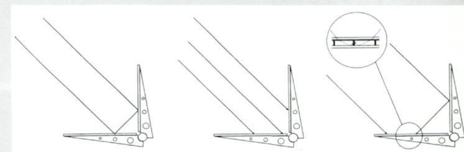
Oben: Aufbau einer Lamelle; unten: die drei Typen der gebrauchten Sonnenschutzlamellen.
