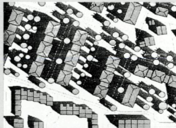
Links: Mit dem Simulationsprogramm Gosol kann die Energiebilanz jedes einzelnen Gebäudes eines Baugebiets ermittelt werden.
