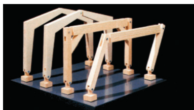
Tragwerksmodelle zum Anfassen und Ausprobieren, links: Gurtträger, Steinbogen, Zweigelenkrahmen, rechts: Hängekonstruktion, Faltwerk, gegenseitig gekrümmte Schale
