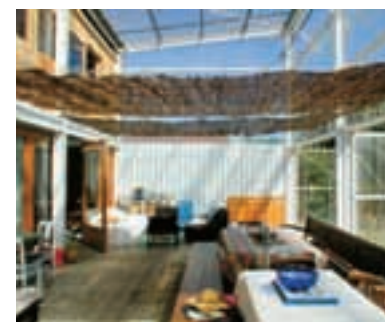
Für das Haus Latapie entsteht aus gängigen Materialien aus dem Baumarkt eine klimatische Pufferzone, die sich die Bewohner individuell aneignen können. Bild oben: Philippe Ruault, unten: Lacaton & Vassal Architectes
