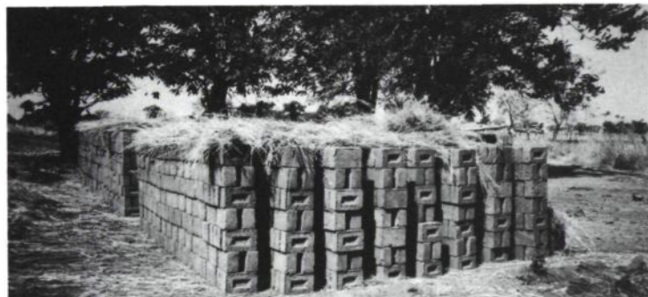
Lufttrocknung der gepreßten Lehmsteine
