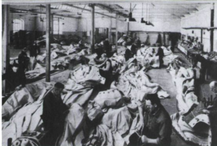
Fügen der Membranteile. Zeltmacher in Strohmeyersdorf um 1960
