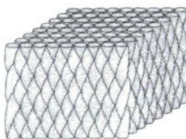
multiaxiales mehrlagig gewirktes Gewebe
