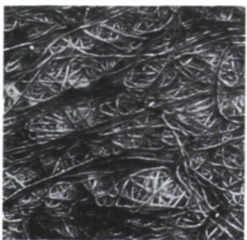
Elektronenmikroskopische Aufnahme: Feinstruktur Faservlies
