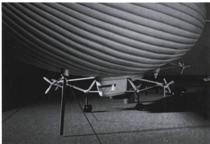
Buro Happold entwarf dieses Hochgeschwindigkeitsluftschiff 1989. Da in den Drehbewegungen bei Geschwindigkeiten bis zu 180 km/h extrem hohe Spannungen auftreten, mußte ein völlig neues Konstruktionssystem entwickelt werden.
