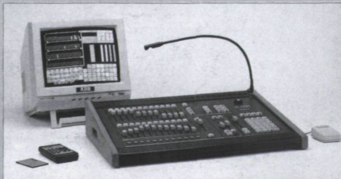
Das Lichtsteuersystem Tenor mit Bildschirm, Maus, Fernbedienung und Memocard.
