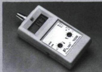
Strahlungs-Messgerät zur berührungslosen Temperatur- und Wärmestrommessung.
