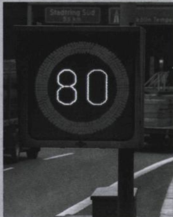
Wechselverkehrszeichen mit Mikrorasterdisplay.
